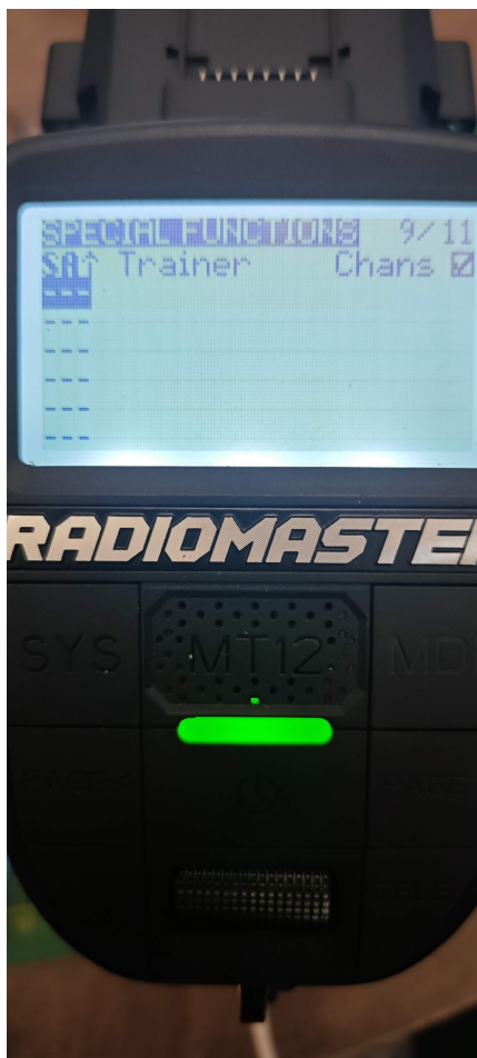
MT12 — przykład aktywowania funkcji specjalnej Trainer przełącznikiem
